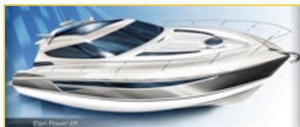
Elan aus Slowenien präsentiert als Deutschland-Premiere die Power 48' (etwa 14,60 m) als größeres Schwesterschiff der bereits etablierten Modelle Power 35' und Power 42'. Neu sind die absenkbare Badeplattform und die Möglichkeit unter zwei Antrieben starre Welle oder Volvo Penta-IPS bei zu wählen.
