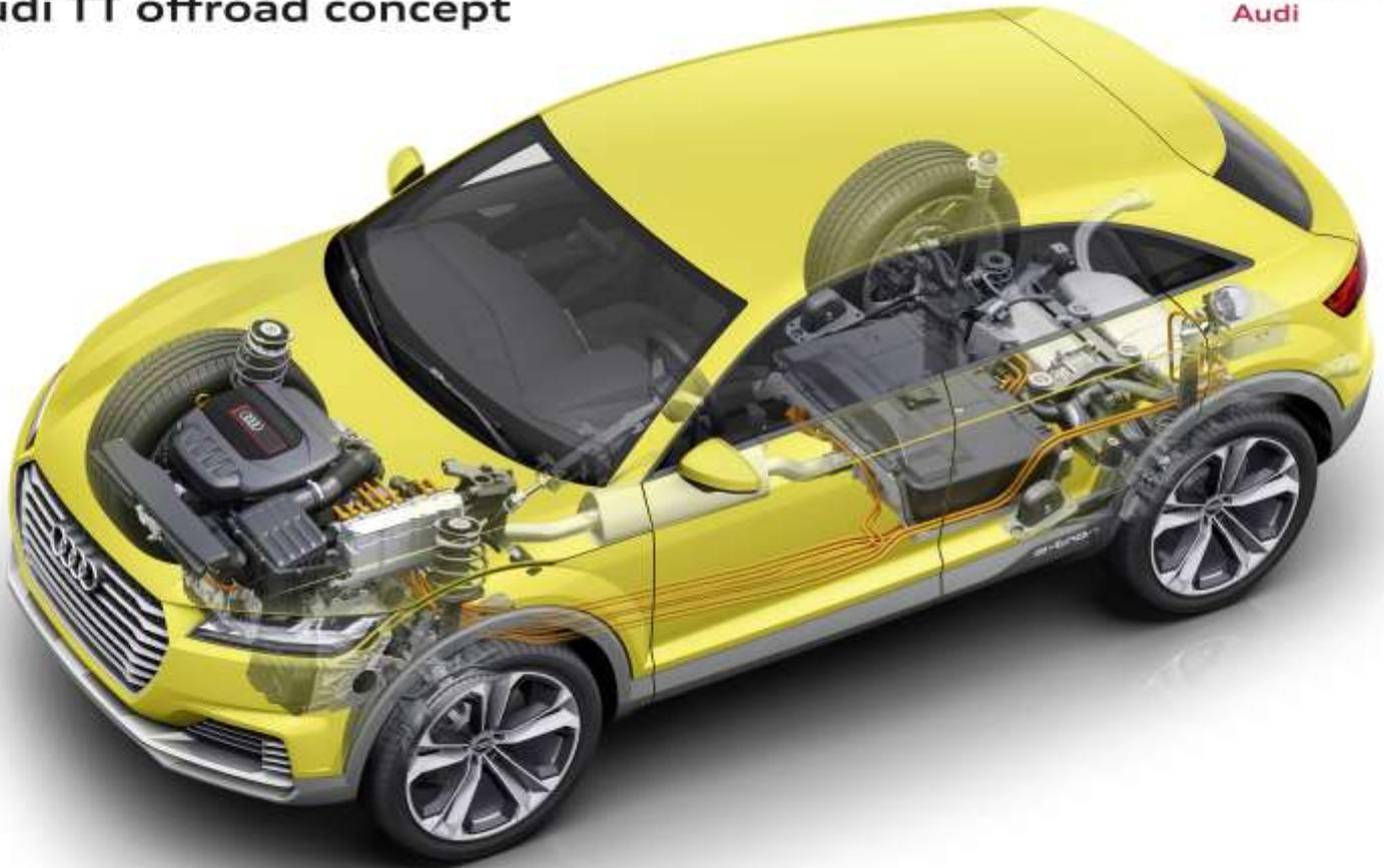
Wenn der Fahrer den Fuß vom Fahrpedal nimmt, aktiviert er den Freilauf und damit das „Segeln“. Bei niedrigerem Tempo und beim Bremsen erfolgt hier eine Rekuperation. Mit den Funktionen „Hold“ und „Charge“ im Bediensystem MMI lässt sich der Ladezustand der Batterie gezielt beeinflussen, etwa um elektrische Energie für die letzten Kilometer am Zielort zu sammeln.
