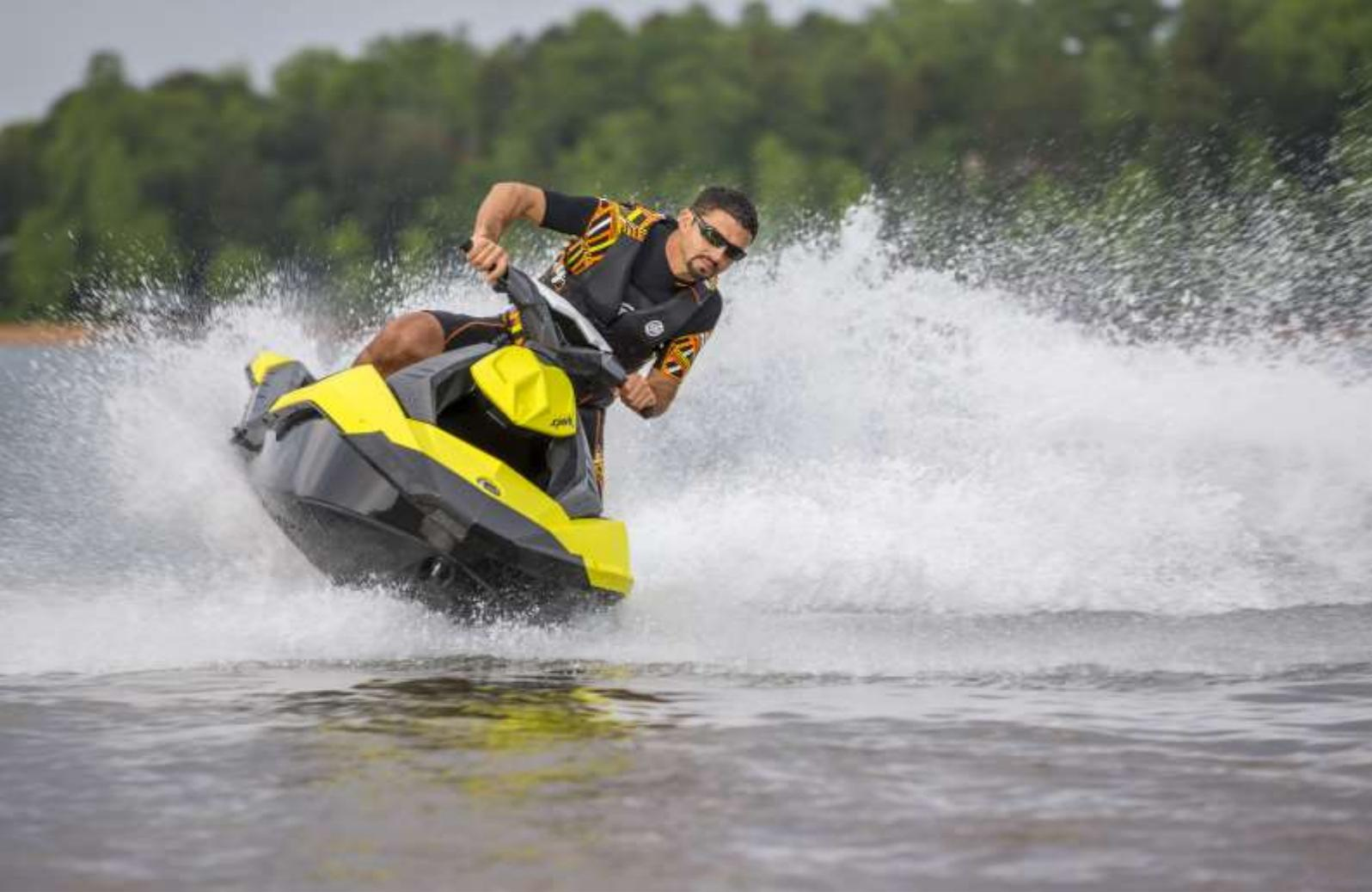
Angetrieben durch Umweltüberlegungen und den Wunsch, das Gewicht dieses Jetboots noch weiter zu verringern, entwickelten die Ingenieure von BRP ein neues Material für die „Außenhaut“ des Sea-Doo Spark. Drei Jahre Entwicklungsarbeit resultierten in der Perfektionierung von Polytec™, einer optimierten Mischung aus Polypropylen und Glasfaser, die speziell für Anwendungen im Bereich von Rumpf und Deck bei Jetbooten konzipiert wurde.
